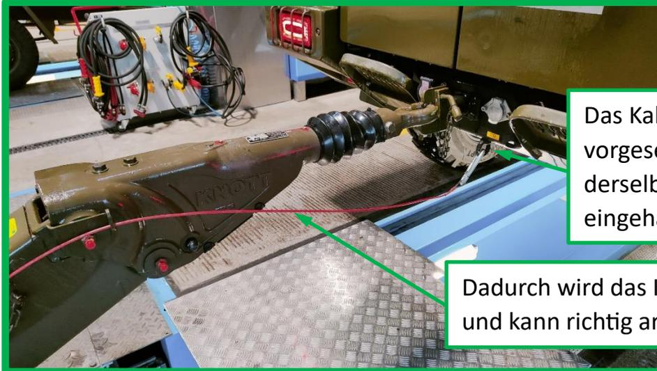
Das Kabel wird an der dafür vorgesehenen Öse und auf derselben Seite wie das Kabel eingehängt!
