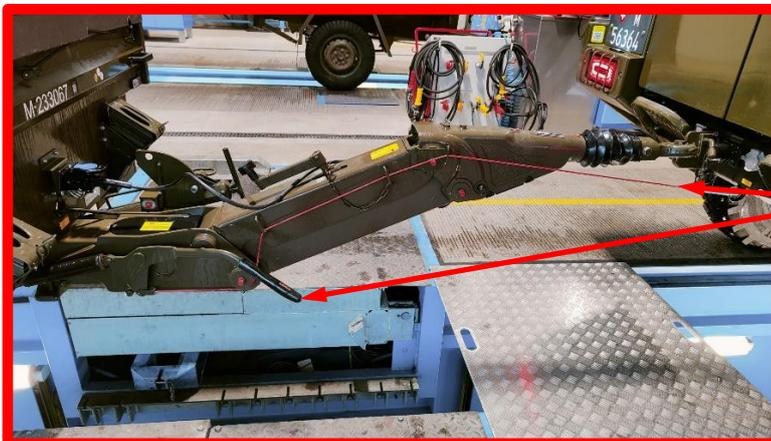
Sobald die Handbremse losgelassen wird, ist das Seil gespannt!
